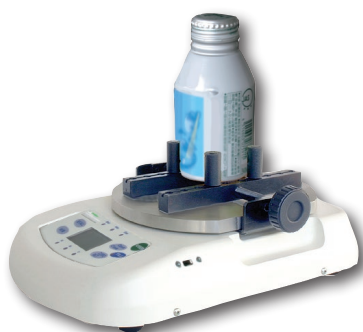
P.P.キャップの開栓・閉栓力
