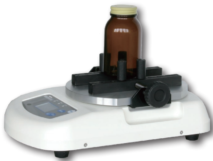
スクリューキャップの開栓・閉栓力
