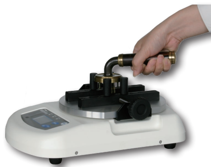
ドアレバーのトルク測定
